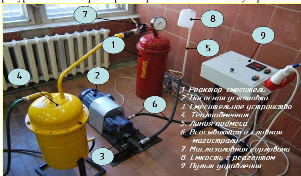
рис. 6 Установка для получения биодизеля
