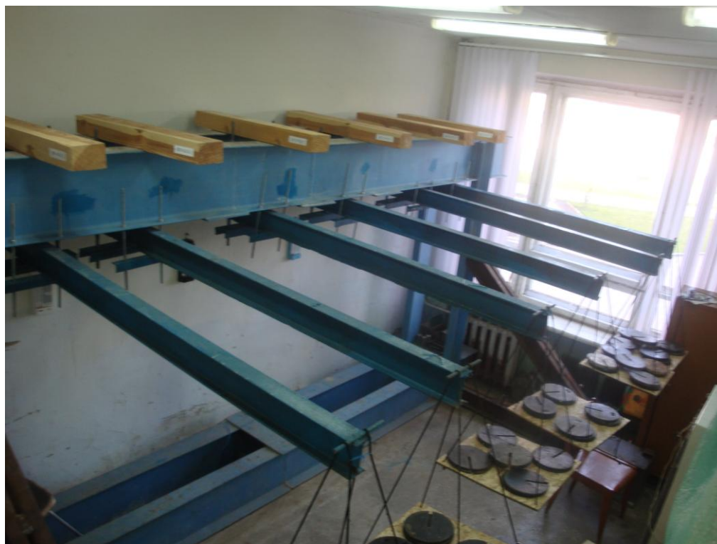
Рисунок 3 – Общий вид стелла для проведения длительных испытаний деревянных образцов со стержнями, работающими на выдергивание
