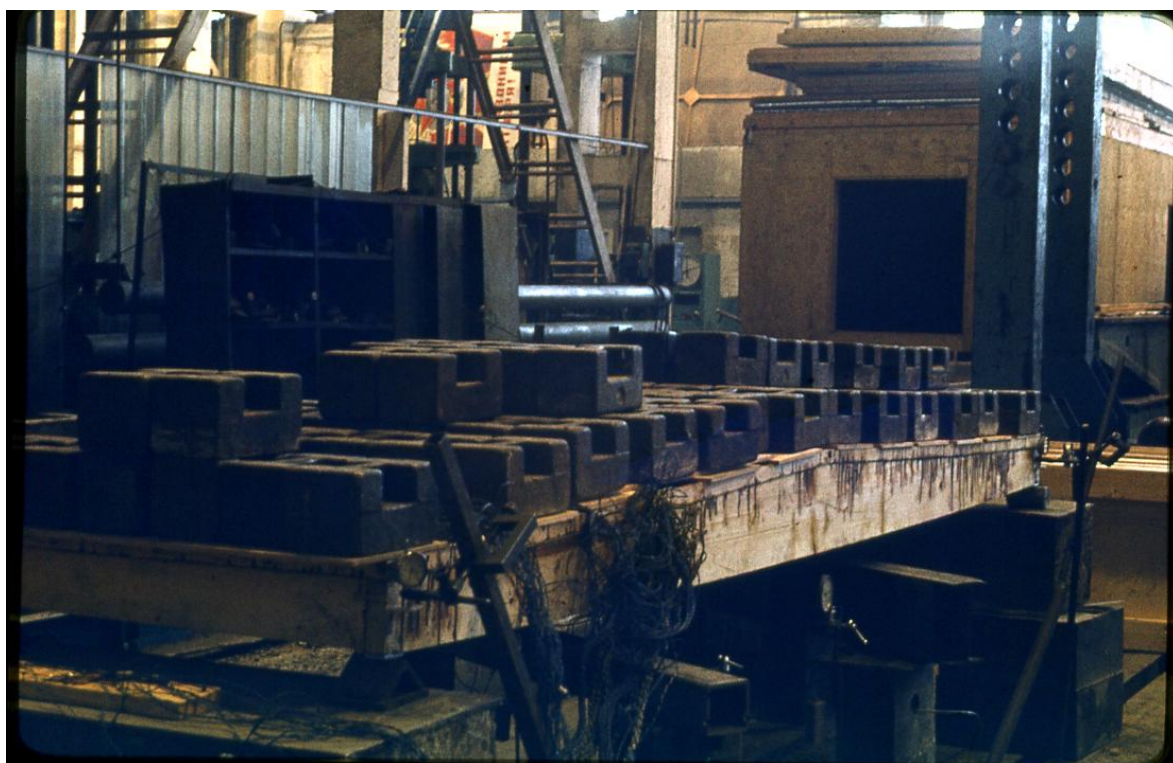
Фото 2. Испытания совмещенных клеефанерных конструкций для строительства полносборных домов
