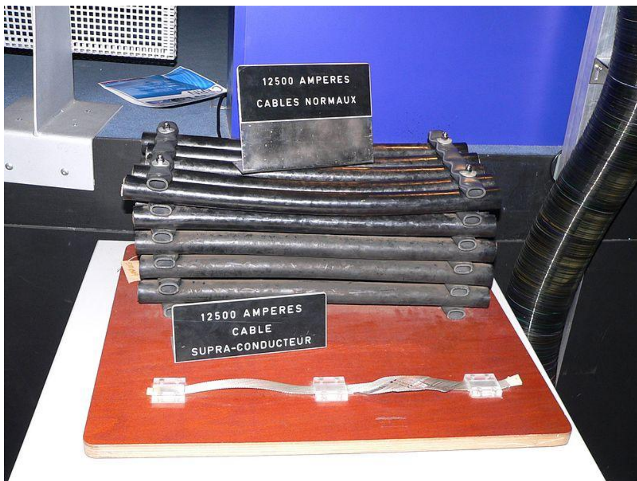
Рисунок 6 - Токоведущая способность СП кабеля.
