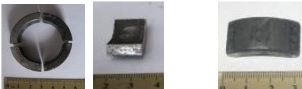
Рисунок 1 – Вид сегментов, вырезанных из трубы
