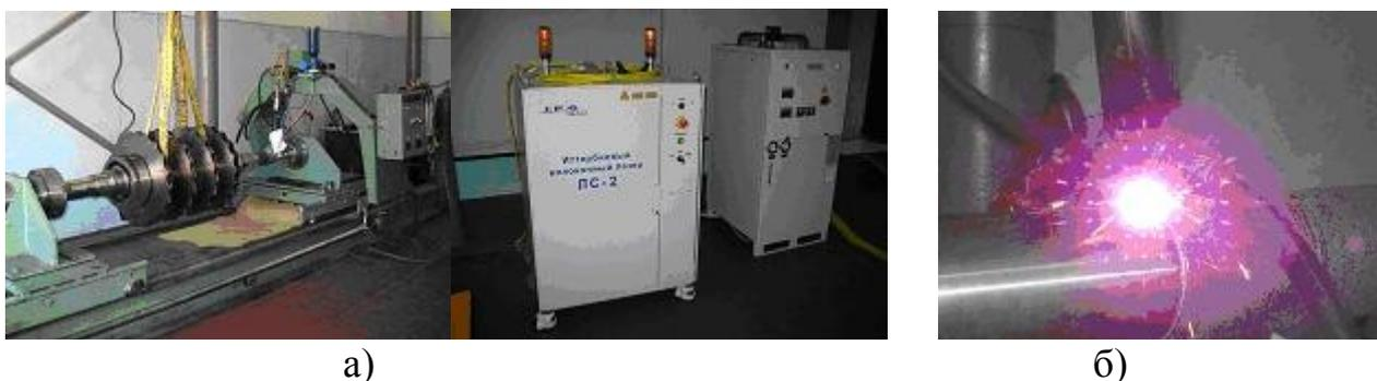
Рисунок 1 – Внешний вид комплекса лазерной наплавки (а), процесс наплавки (б).
