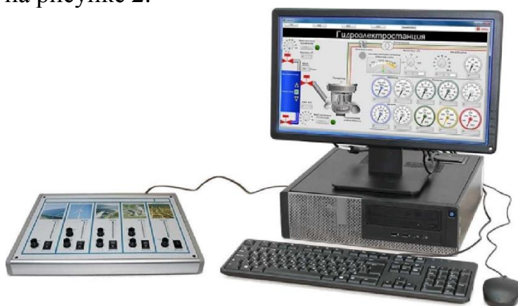
Рисунок 2- Лабораторный стенд «SCADA -система в электроэнергетике»
