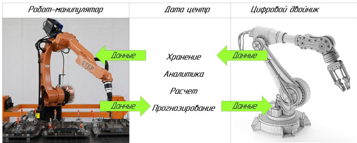
Рисунок 1 – Схема взаимодействия между роботом-манипулятором в цеху и его виртуальной математической моделью
