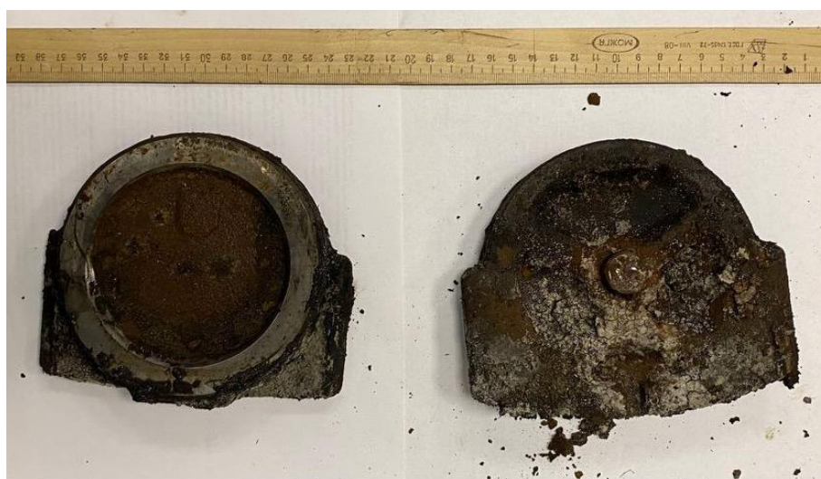
Рисунок 2 – Состояние клина после эксплуатации (вид с первой стороны)
