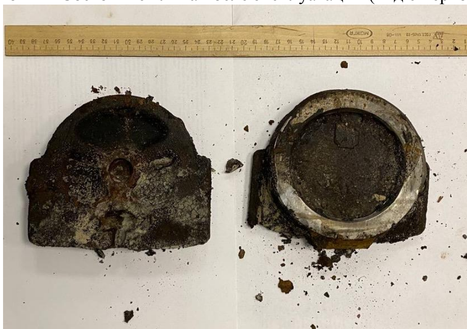
Рисунок 2 – Состояние клина после эксплуатации (вид с первой стороны)
