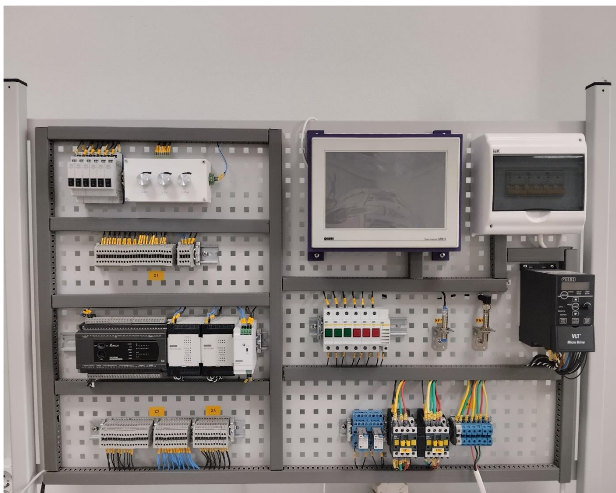
Рисунок 3 – Вид лабораторного комплекса при использовании ПЛК «Delta EX2»
