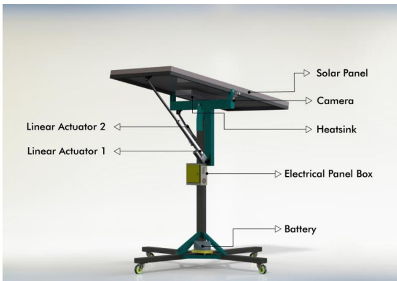
Рисунок 2 — Одноосевая система слежения за солнцем
