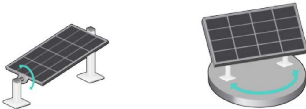
1. Одноосный вертикальный трекер 2. Одноосный горизонтальный трекер Рисунок 2 – Одноосные трекеры
