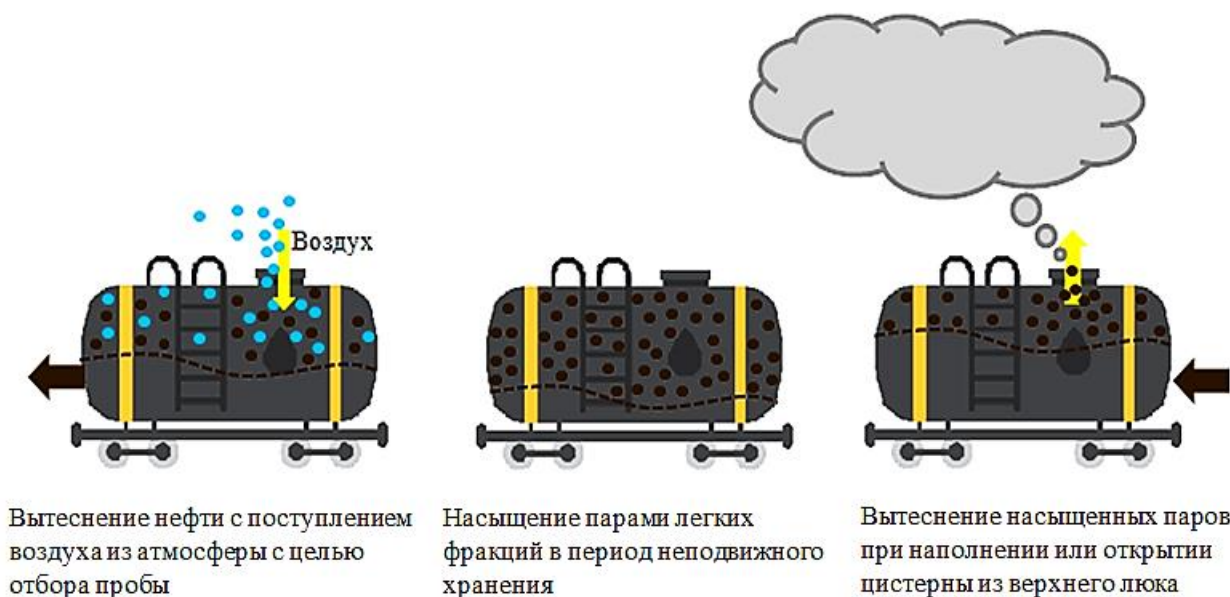
Рисунок 2 – Схема процесса «большого дыхания» на примере резервуара
