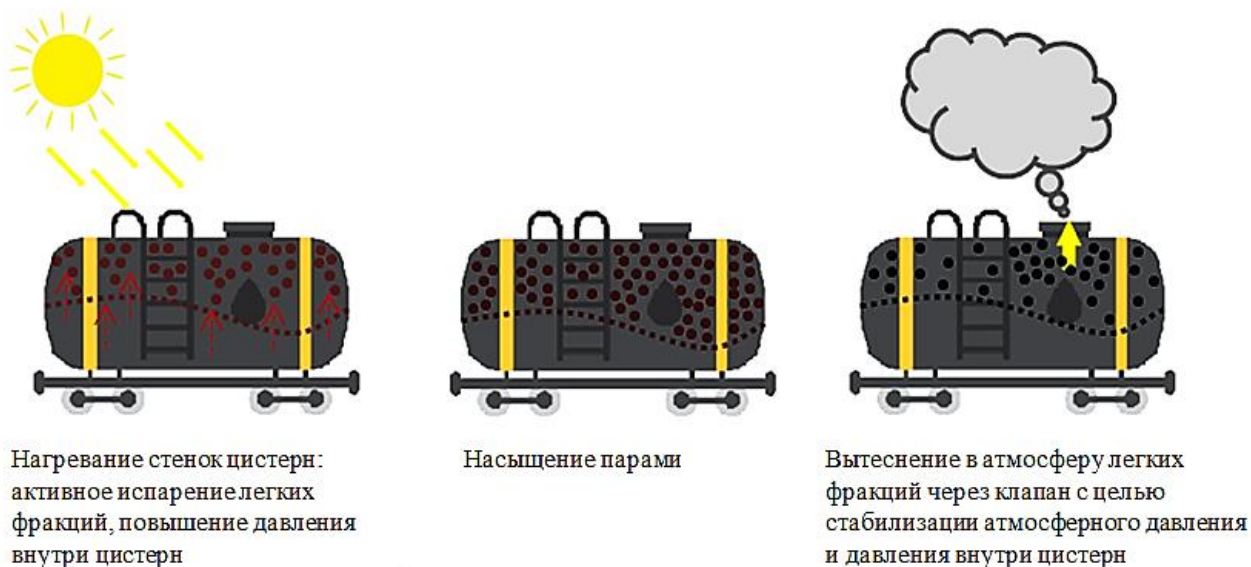
Рисунок 1 – Схема процесса «малого дыхания» на примере резервуара
