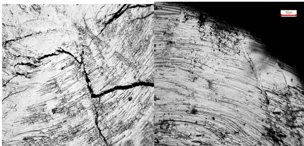
Рисунок 3 – Трещина в образце карбида вольфрама с кобальтом при увеличении \times 100 и край образца с трещиной при увеличении \times 100
