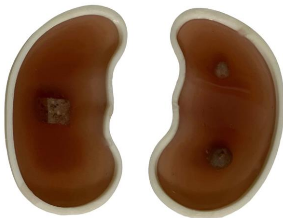
Рисунок 1 - Разработка научного коллектива кафедры медико-биологической техники - «Фантом почки, пораженной мочекаменной болезнью»
