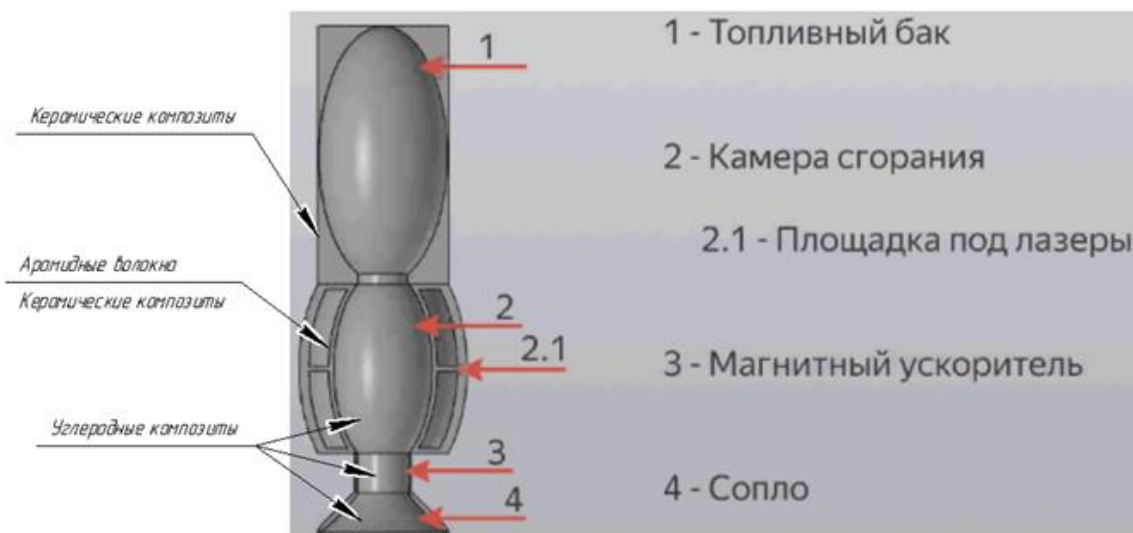
Рисунок 1 – Использование композитов в конструкции плазменного ракетного двигателя
