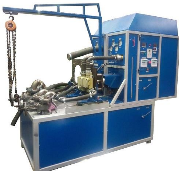
Рисунок 1 – Стенд для обкатки и испытания маслоагрегатов и гидравлических насосов, устанавливаемых на мощные двигатели внутреннего сгорания и редукторы
