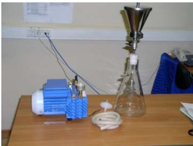
Рисунок 1 – Односекционная установка мембранной вакуумной фильтрации
