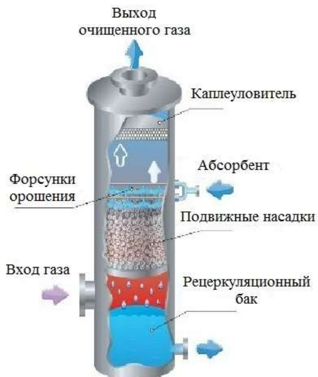
Рисунок 1 - Конструкция скруббера.
