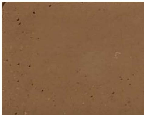
Рисунок 2 – Изображение керамического образца, высушенного при комнатной температуре
