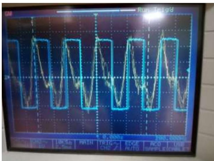
**Рис. 5.** Осциллограммы исходного сигнала генератора задающего модуляцию магнитного поля с частотой 200 Гц (синий меандр) и полезного периодического когерентного сигнала в виде желтого трека.
