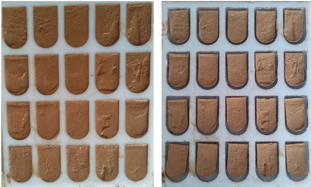
Рисунок 1 – Изображение шликерной заливки образцов в силиконовые формы и высушенных образцов
