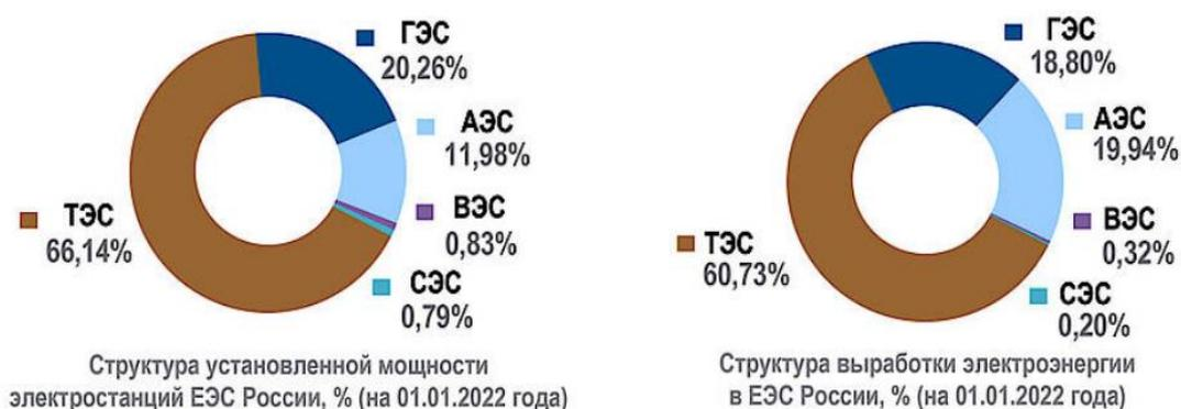
Рисунок 1- Структура установленной мощности электрических станций и структуры выработки электрической энергии
