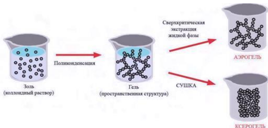
Рисунок 3- Стадии получения аэрогелей на основе органического типа
