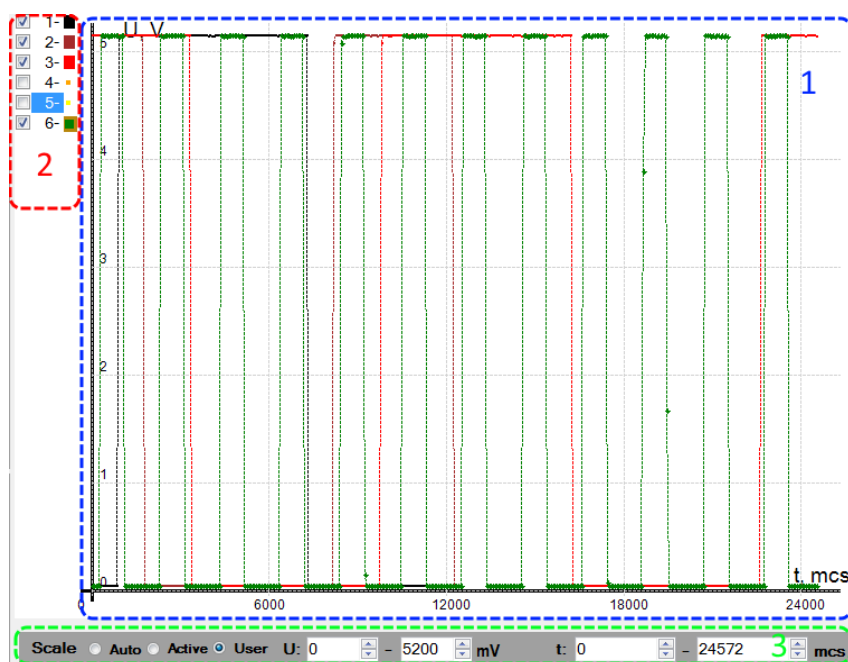
Рисунок 8– Вид графической области программы. 1 – графики в декартовых координатах « U(t) » с заданным масштабированием; 2 – интерактивный список выбора отображаемых кривых; 3 – панель выбора режима масштабирования
