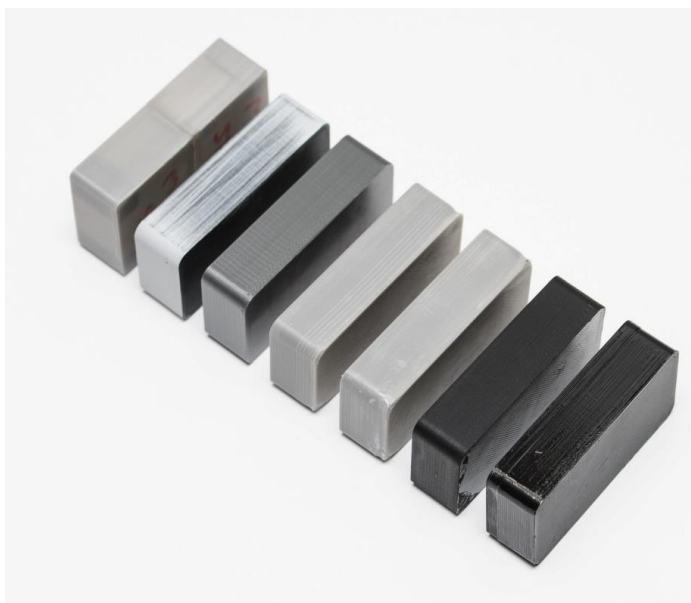
Рисунок 1 - Прошедшие постобработку FDM-распечатки (слева направо): холодная сварка, заполнение пустот, необработанная, зачищенная шкуркой, отполированная, покрашенная и покрытая эпоксидкой.
