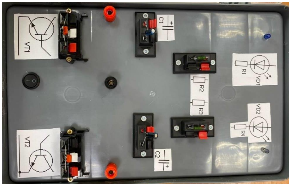
Рисунок 2 – Внешний вид лабораторного стенда с подключенными резисторами, конденсаторами и транзисторами в пружинных клеммах
