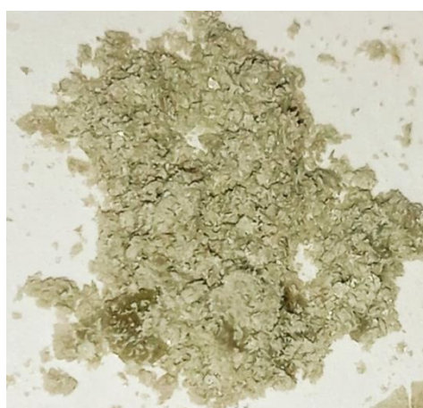
Рисунок 4 – образец поликристаллического флогопита после механического дробления монокристалла.
