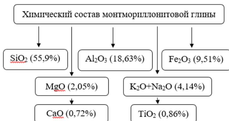
Рисунок 2 – Химический состав монтмориллонитовой глины
