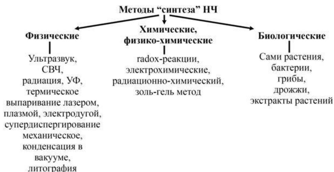
Рисунок 1 – Методы синтеза наночастиц металлов [2].
