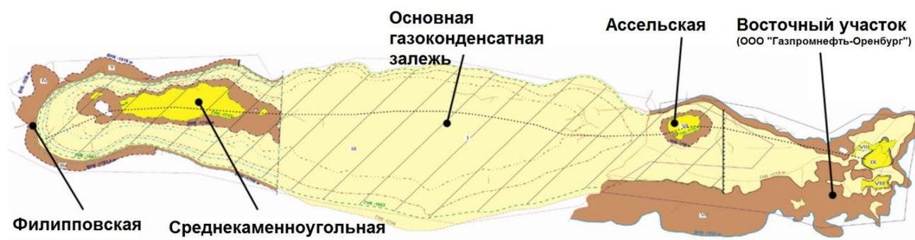
Рисунок 1 – Схематичное расположение залежей нефти Оренбургского НГКМ. [1]
