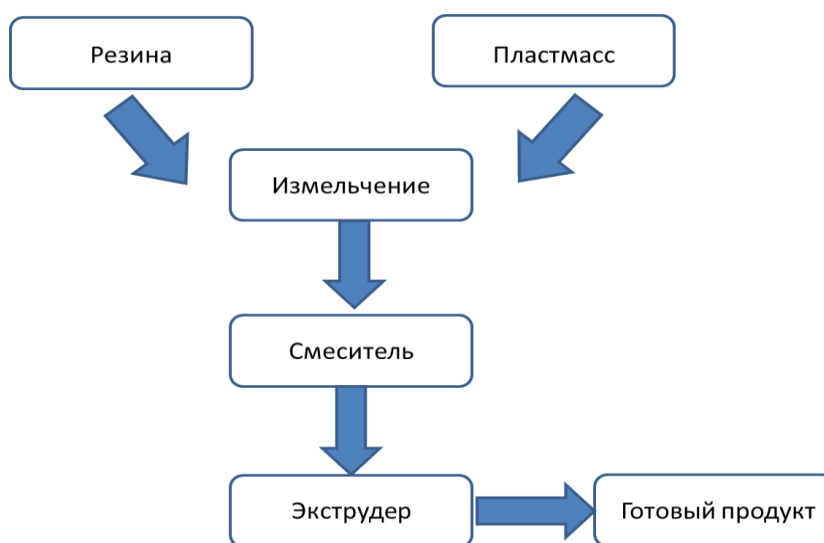
Рисунок 1 – Предлагаемая технологическая схема по совместной утилизации отхода пластика и резины
