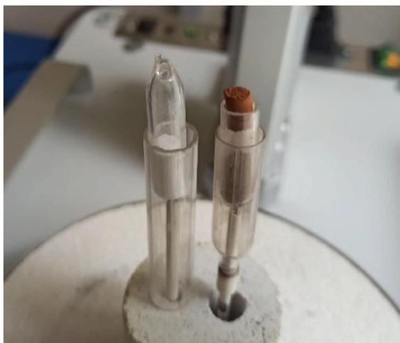
Рисунок 5 – Эффект «выброса» части образца монтмориллонита из измерительного сосуда. Эффективный диаметр частиц  $d \leq 40$  мкм
