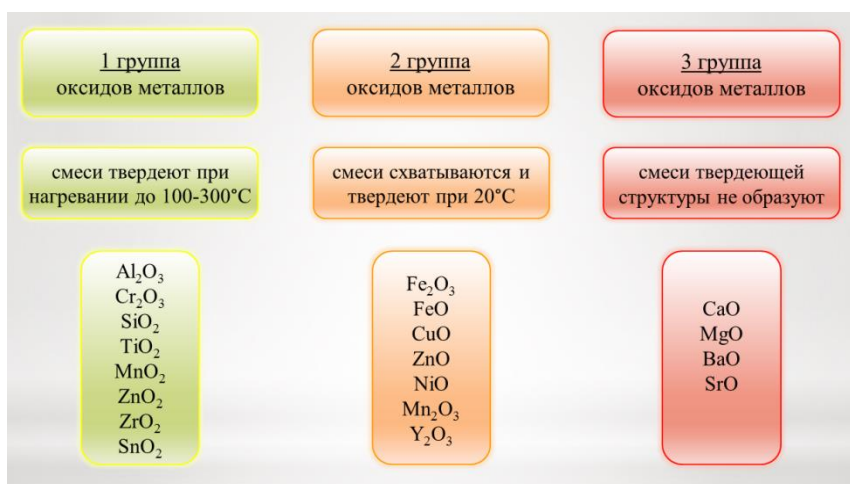
Рисунок 1 – Взаимодействие оксидов металлов с ортофосфорной кислотой
