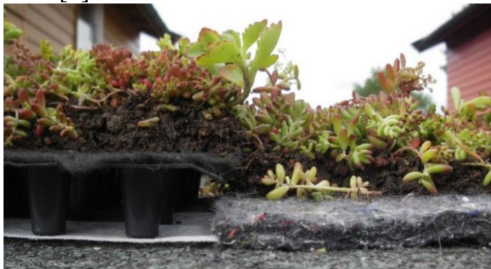
Рисунок 5 – Дренажный коврик из перфорированного «пластика для ударов» и войлочный коврик толщиной 3 см.
