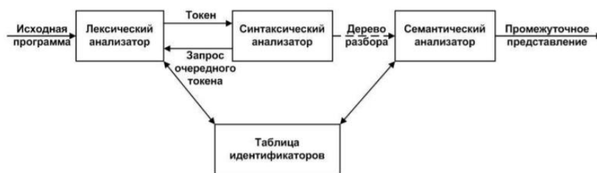
Рисунок 4 – Место синтаксического анализатора в структуре компилятора
