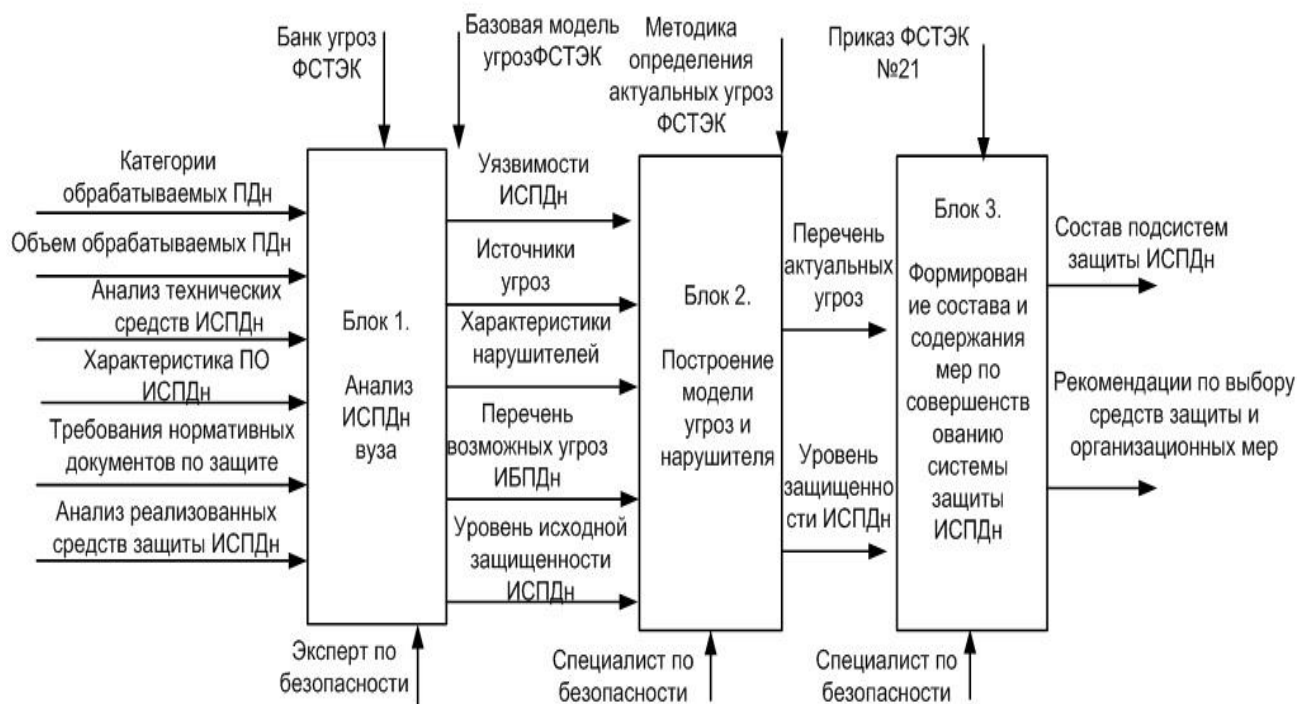
Рисунок – Функциональная модель выбора структуры системы защиты ИСПДн
