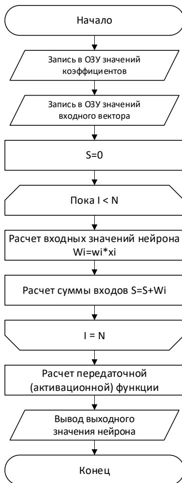
Рисунок 3 – Схема алгоритма вычисления выходного значения нейрона
