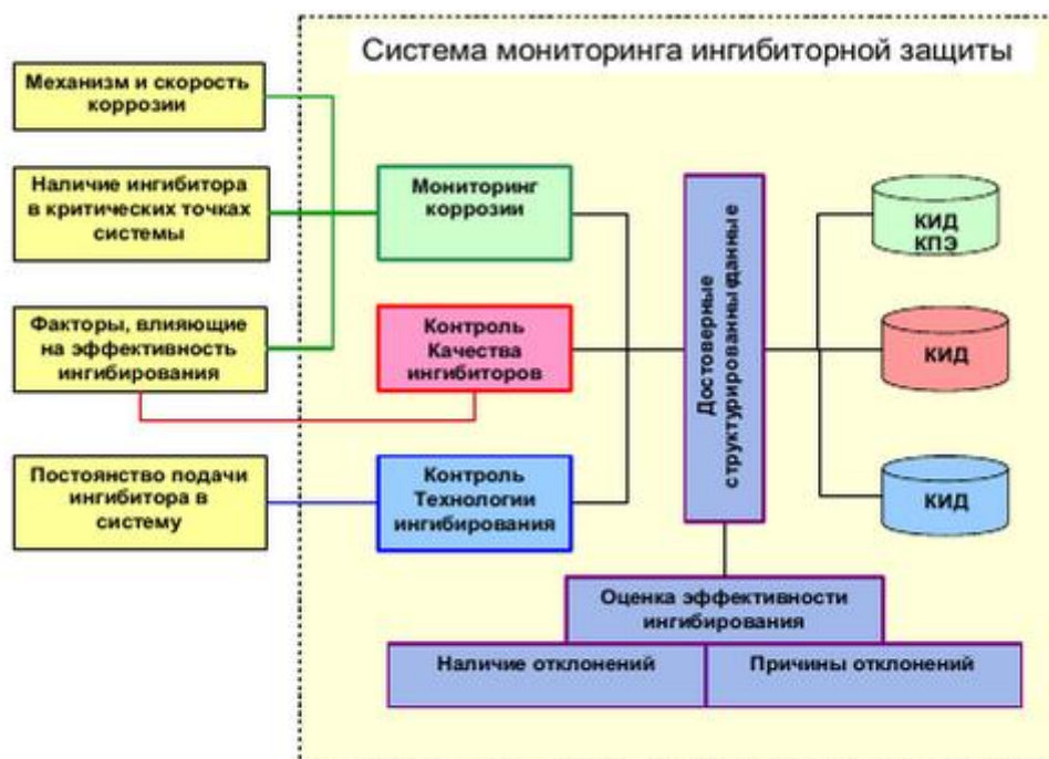
Рисунок 2 – Схема организации мониторинга и ингибирования
