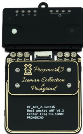
Рисунок 1 – Устройство Proxmark3, используемое энтузиастами для исследования и взлома RFID меток
