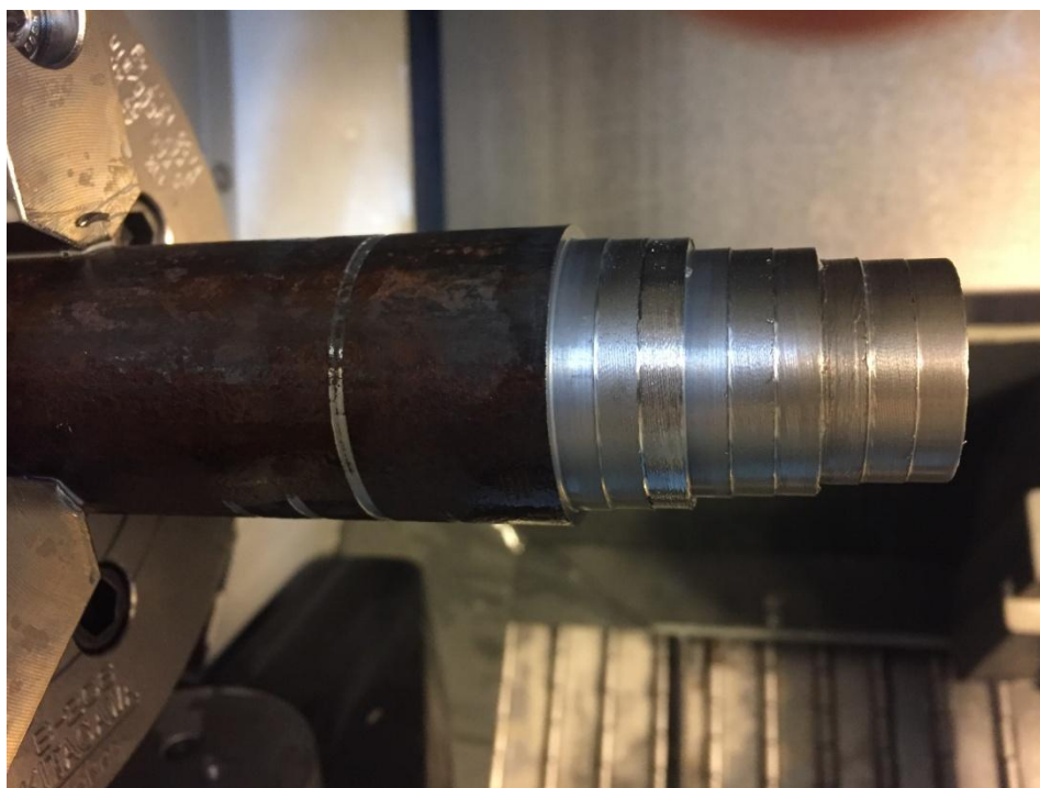
Рисунок 1 – Ступенчатый валик в трехкулачковом патроне станка
