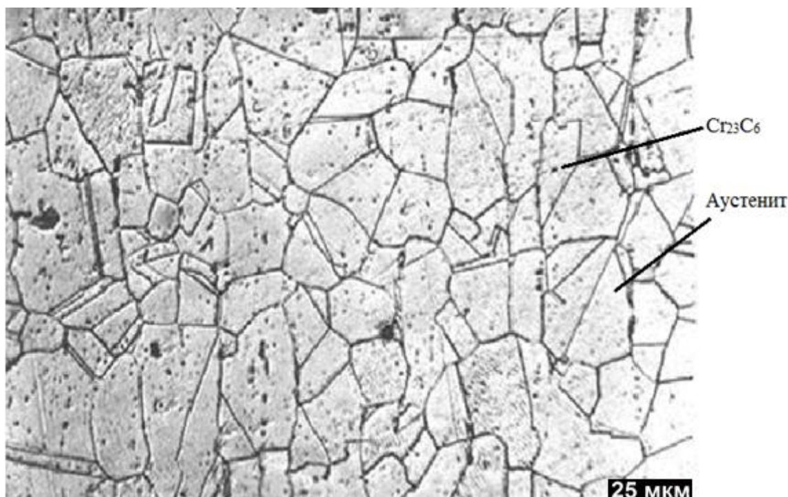
Рисунок 1 - Структура стали 12Х18Н10Т в исходном состоянии
