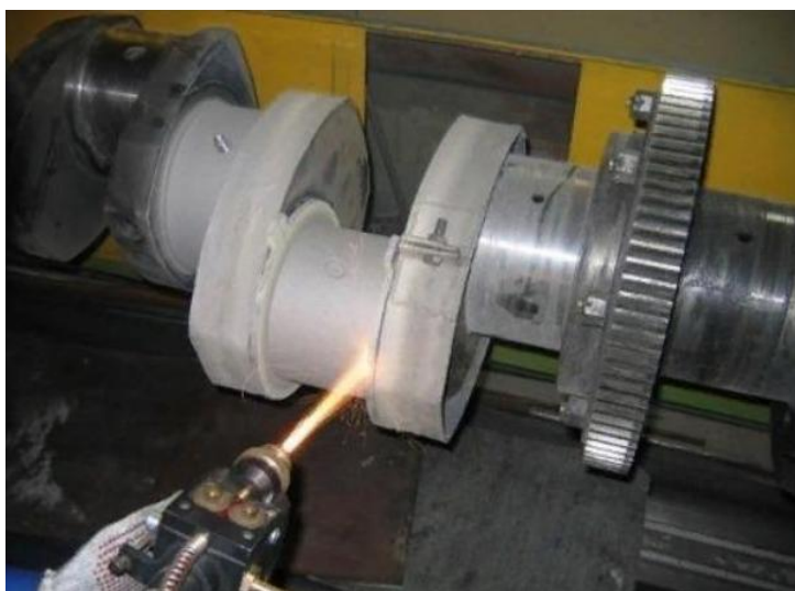
Рисунок 1 – Газопламенное напыление шейки коленчатого вала
