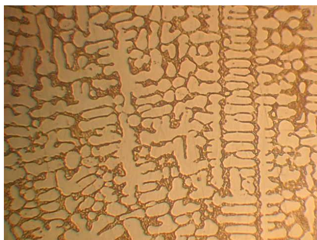
Рисунок 5 – Микроструктура образца после закалки ( T_{\text{зак}}=850\text{ }^{\circ}\text{C} в воде), (твердость 53 HRC), х630.
