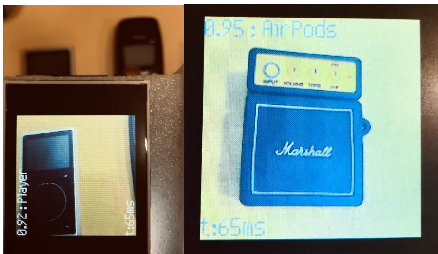
Рисунок 2 – Классификация объектов программным комплексом
