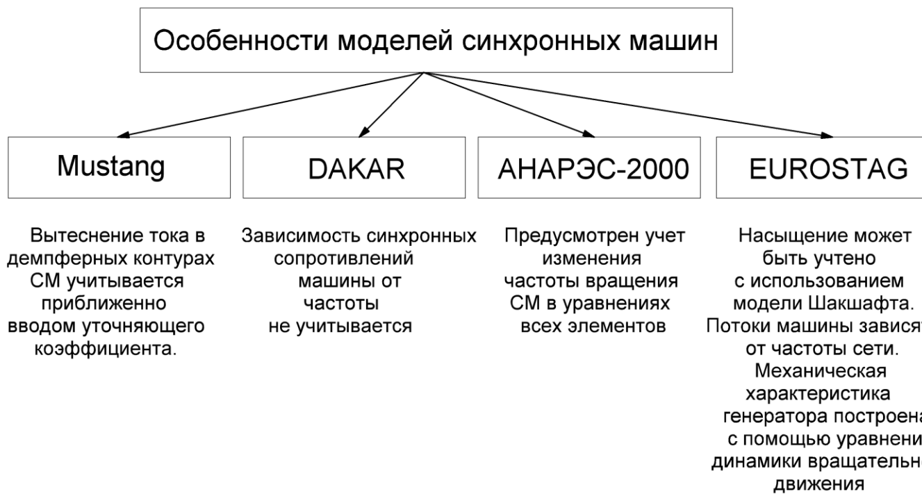
Рисунок 2 – Особенности моделей СМ, используемых в программах по расчету динамики энергосистем
