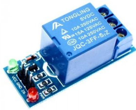
Рисунок 6 – Электромагнитное реле для имитации срабатывания кнопок
