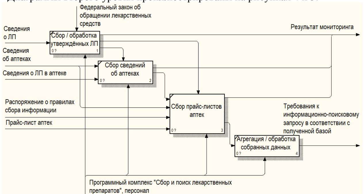
Рисунок 4 – Диаграмма 2-го уровня функциональной модели (нотация IDEF0) блока сбора и обработки первичных данных
