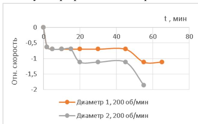
Рисунок 7 – Зависимость относительной скорости экстракции йода от времени извлечения в полулогарифмических координатах (Диаметр 1, 200 об/мин; Диаметр 2, 200 об/мин)
