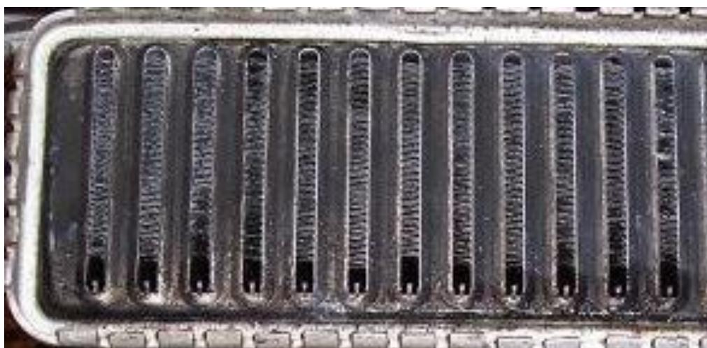
Рисунок 2 – Внутреннее загрязнение охладителя наддувочного воздуха
