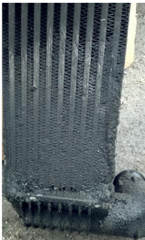
Рисунок 1 – Наружное загрязнение охладителя наддувочного воздуха
