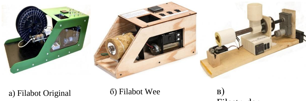
Рисунок 2 – Портативные экструдеры для производства филамента
