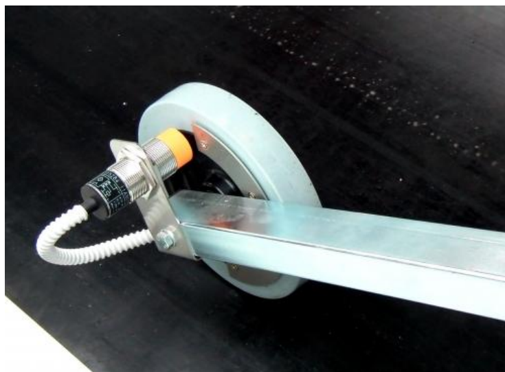
Рисунок 3 – Датчик скорости ленты импульсный
