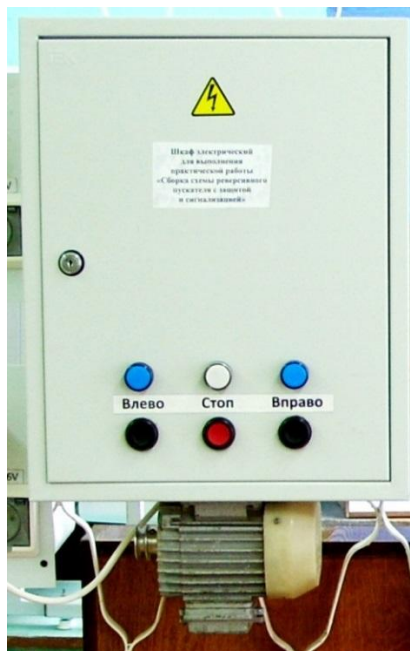
Рисунок 5 - Стенд «Шкаф электрический для сборки схемы реверсивного пускателя с защитой и сигнализацией»
