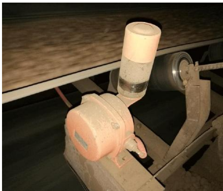
Рисунок 4 – Датчик схода ленты
