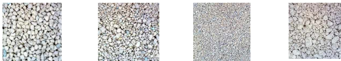
Рис. 1 Микроструктура образцов фракции A,B,C,D x 50.
