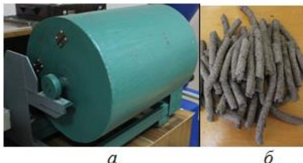
Рисунок 2 – Устройство для определения крошимости готовых экструдированных изделий ППГ-2
