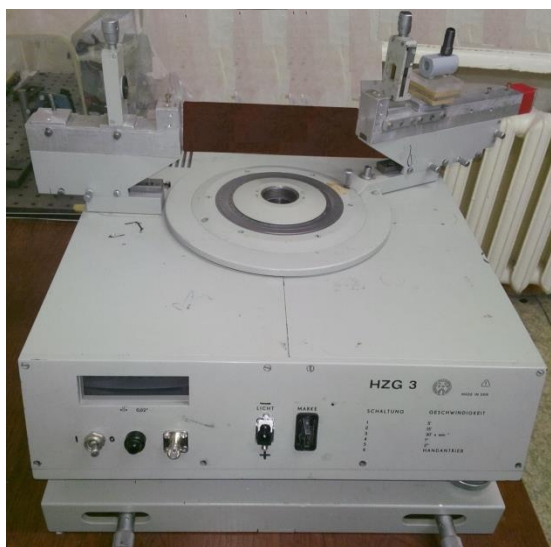
Рис. 1. Внешний вид установки собранной на базе гониометра HZG 3
