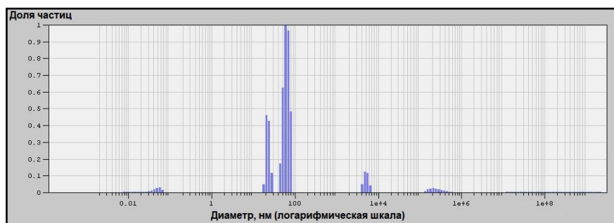
Рис. 5. Распределение частиц магнетита по размерам в растворе, стабилизированном HCl ( c_{\text{HCl}}=0.3 моль/л). Слева на право: 2-ой пик – 22 нм, 3-ий пик – 62 нм.
