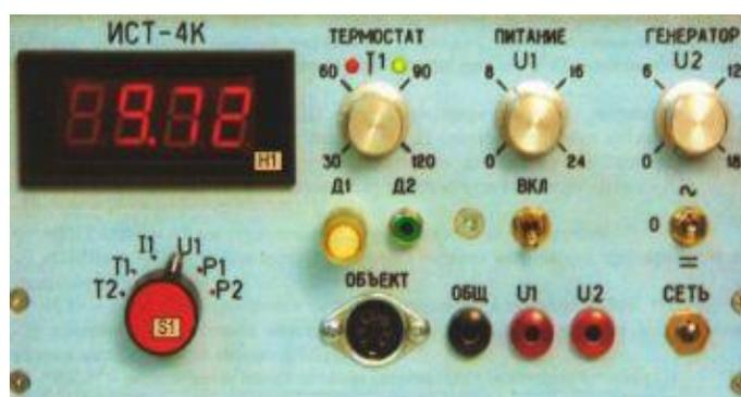
Рисунок 1, б – Передняя панель ИСТ-4К
