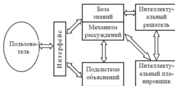
Рисунок 2- Типовая структура экспертной системы.
