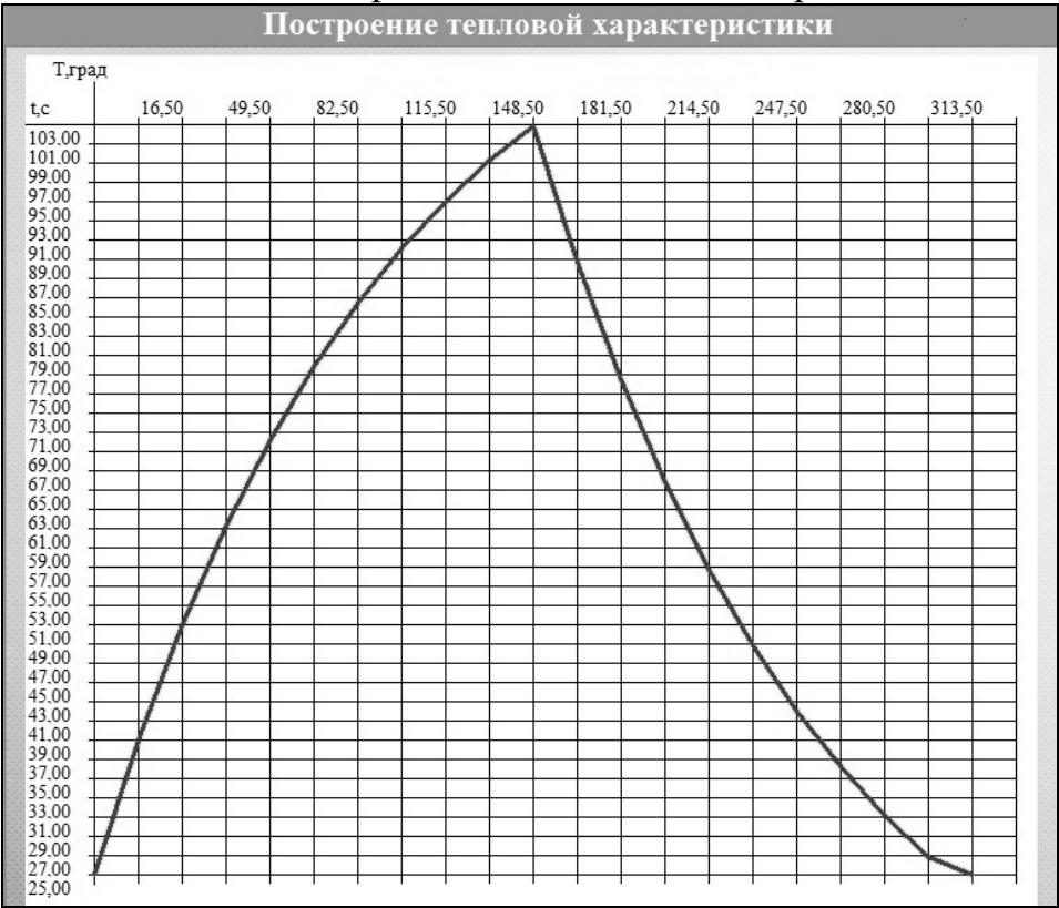
Рисунок 4 – Тепловая характеристика кабеля ВВГ 1х4
