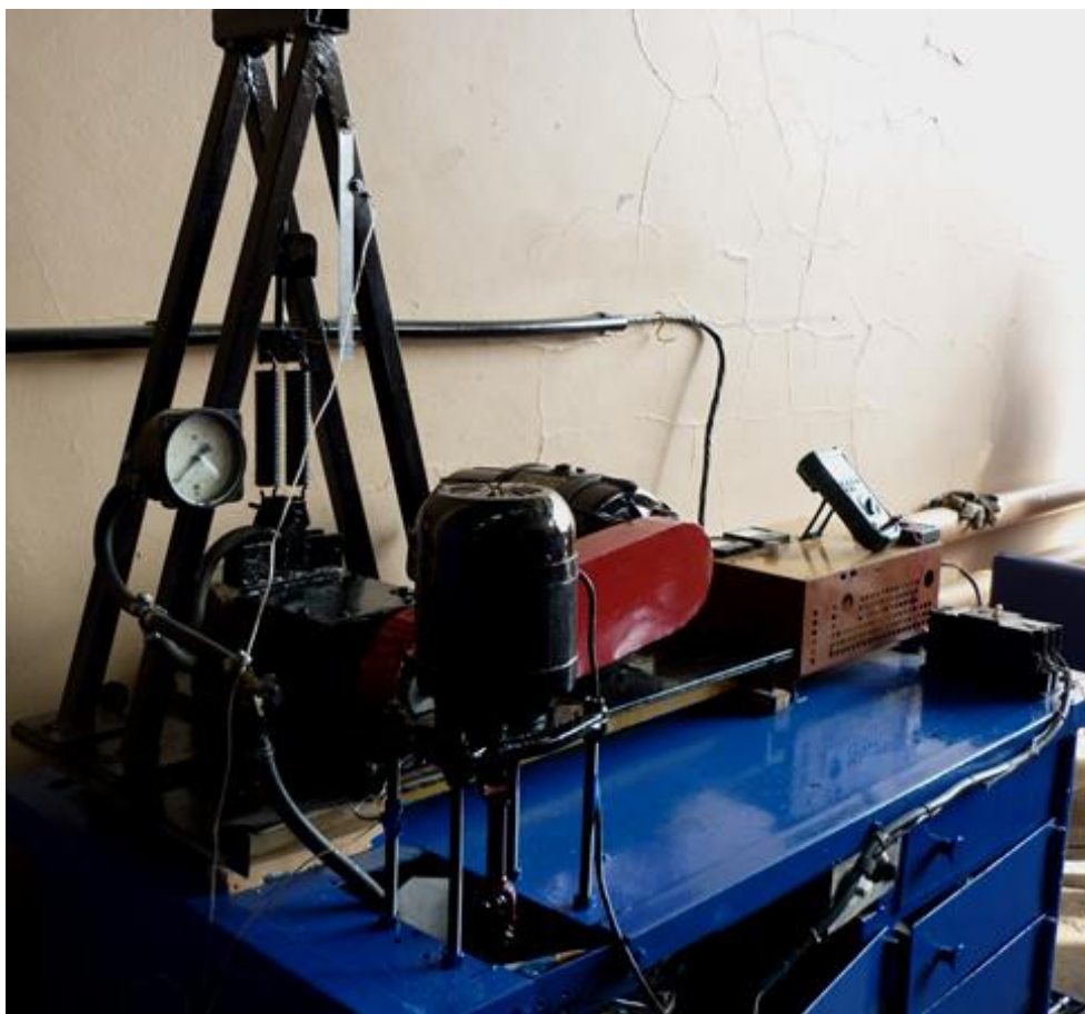
Рисунок 6 - Лабораторная установка для испытания подшипников скольжения
