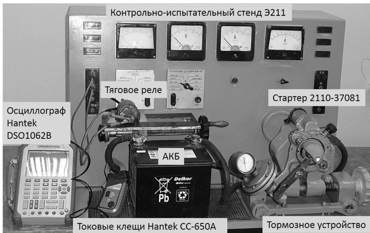
Рисунок 2 – Общий вид стенда для диагностирования автомобильных стартеров
