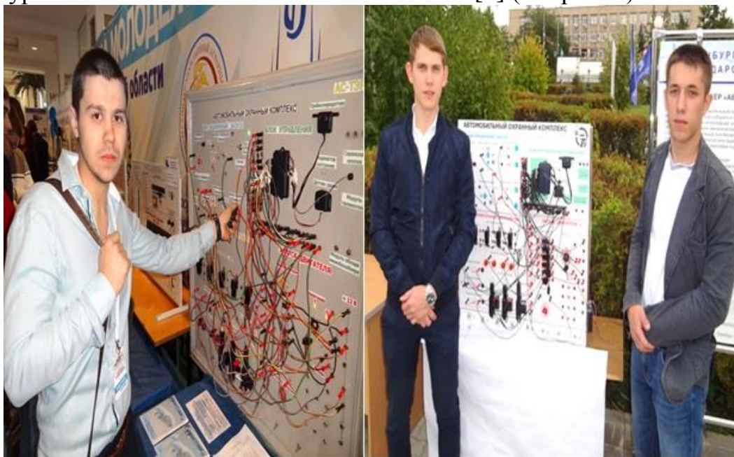
Рисунок 1 – Первый (слева) и второй вариант стенда по обучению сборке схем автосигнализации
