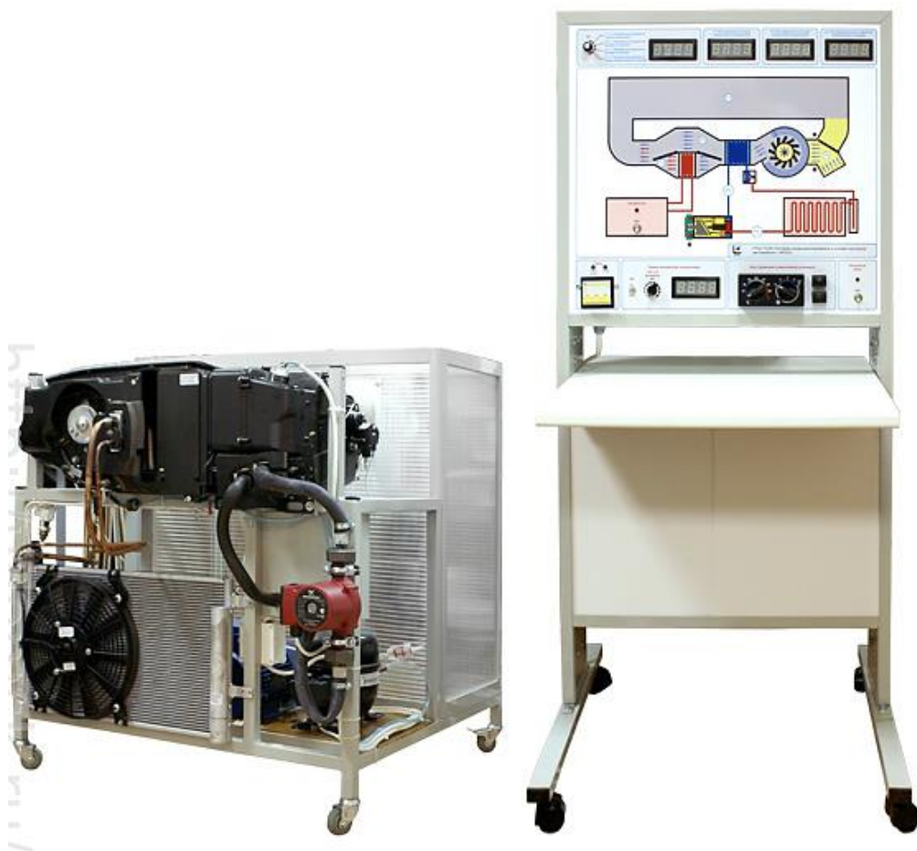
Рисунок 2 – Лабораторное оборудование НТЦ-15.69 «Системы кондиционирования и климат-контроля автомобиля с МПСО»
