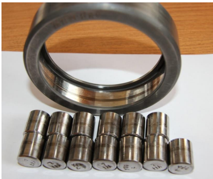
Рисунок 1.17 – Наклеп в виде рисок по центру образующей роликов и дорожки качения наружного кольца подшипника 6-42408K4
