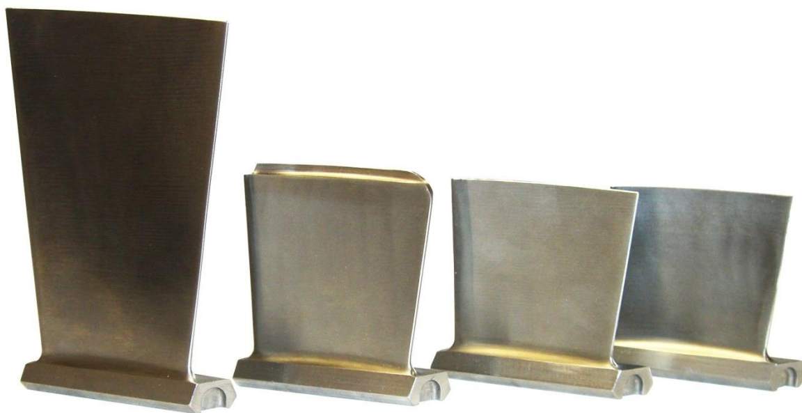
Рисунок 7 – Лопатки компрессора высокого давления из титана.
