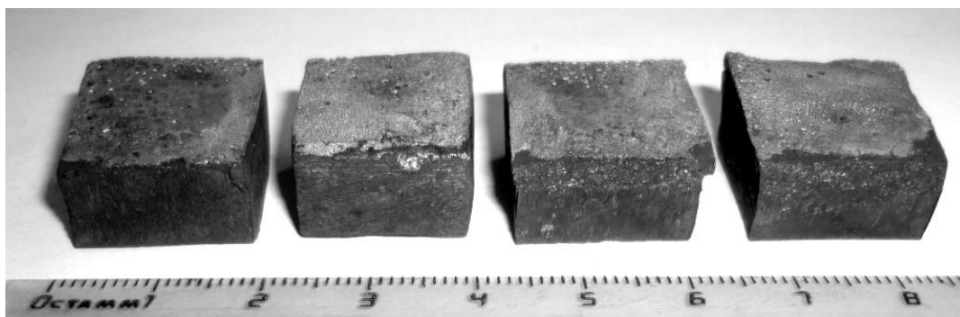
Рисунок 1 – Внешний вид образцов, наплавленных самофлюсующимися твердыми сплавами
