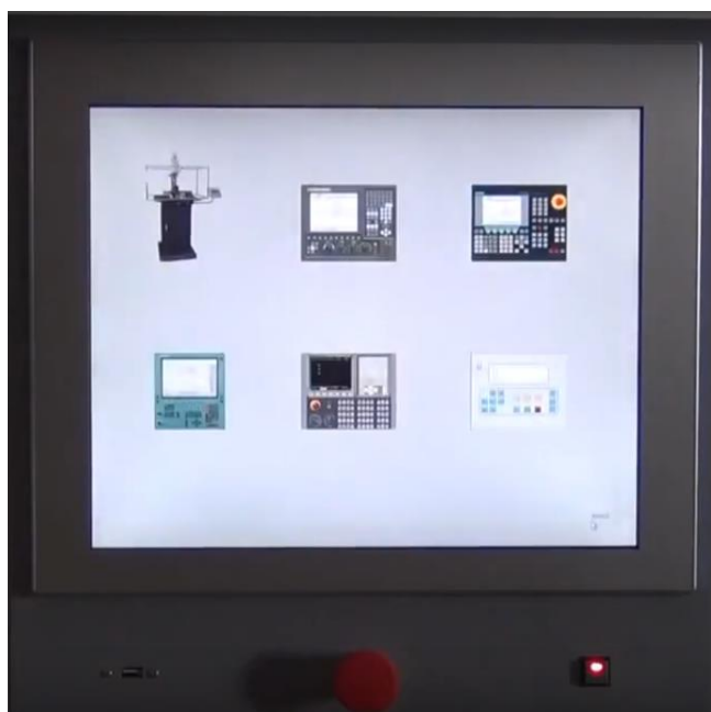
Рисунок 2 – Универсальный пульт оператора со сменным интерфейсом
