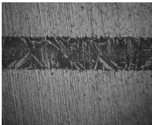
Рисунок 1 – Металлография соединения VT6C+OT4-1 с одной прослойкой титановой фольги, х 200 крат
