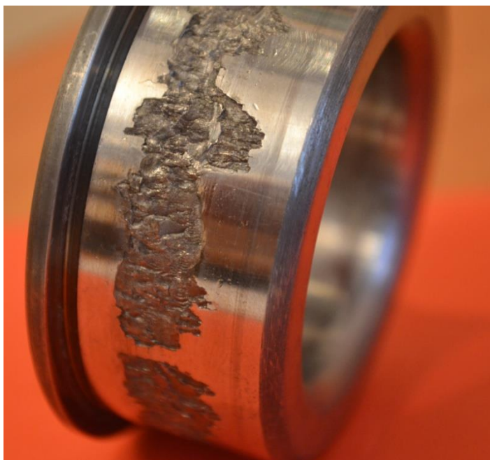
Рисунок 1.16 – Выкрашивание дорожки качения внутреннего кольца подшипника 6-42408K4
