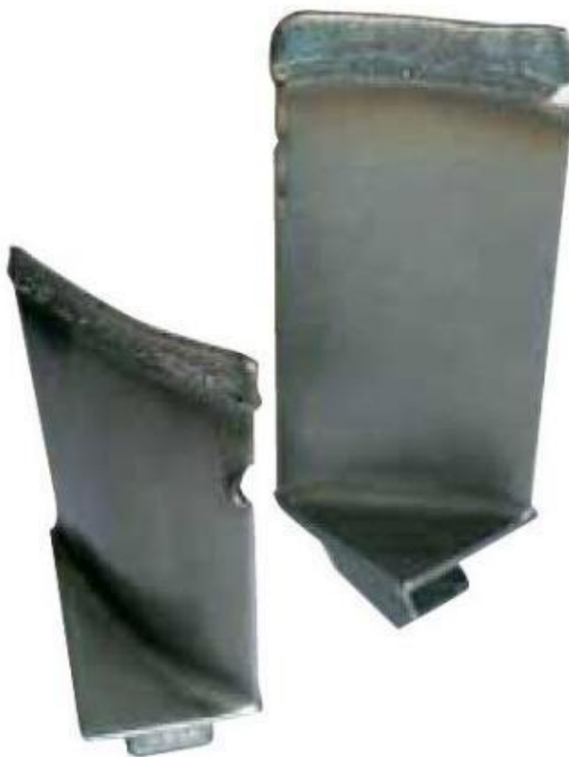
Рисунок 1. Восстановленные лопатки газотурбинных двигателей.
