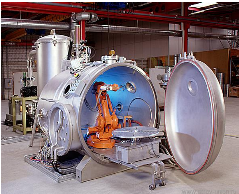
Рисунок 3 – Вакуумная камера для электронно-лучевого покрытия
