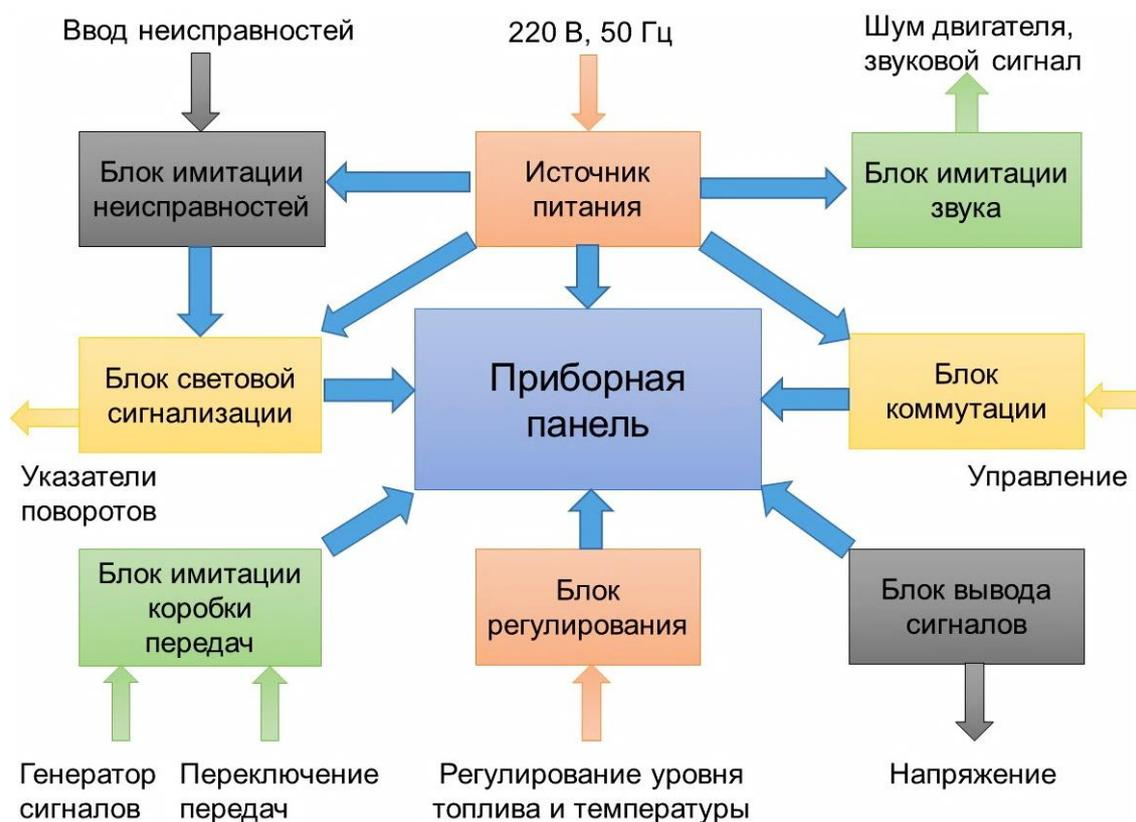
Рисунок 2 – Блок-схема стенда
