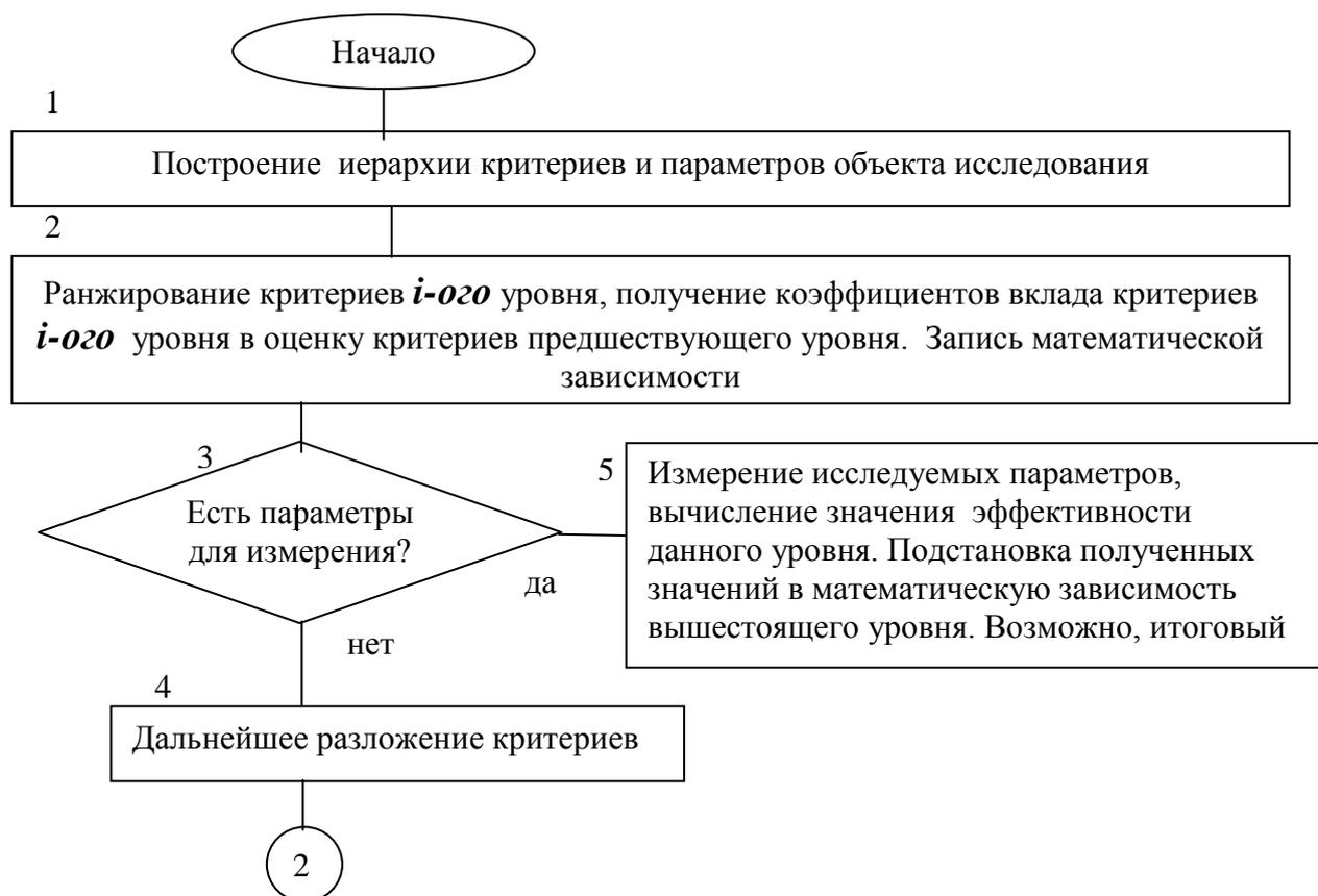
Рисунок 2 - Алгоритм построения математической модели ФК
