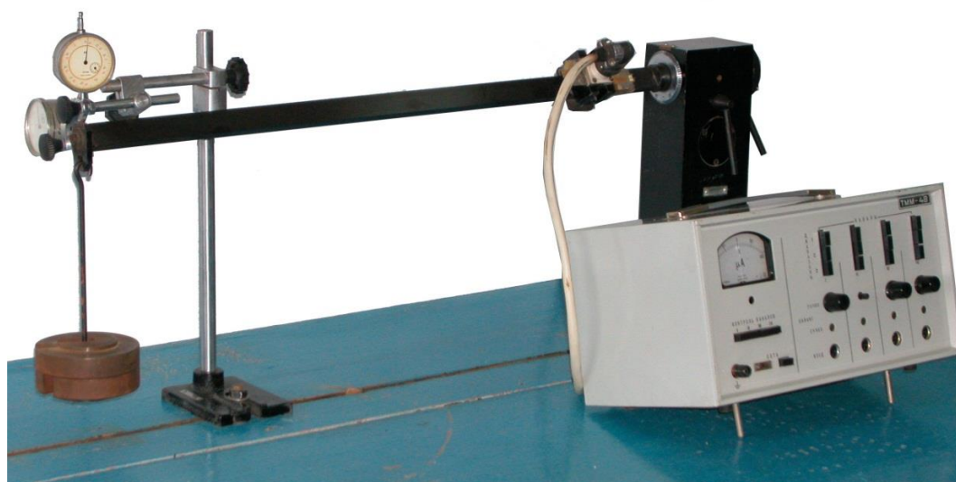
Рисунок 3- Испытание стержня на кривой изгиб
