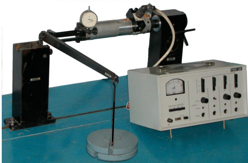
Рисунок 1- Исследование плоского напряженного состояния методом тензометрии
