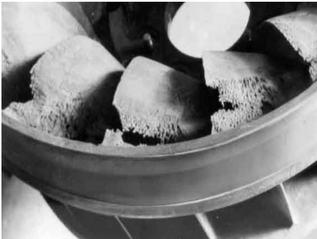
Рисунок 2 – Кавитационная эрозия на рабочем колесе центробежного насоса.
