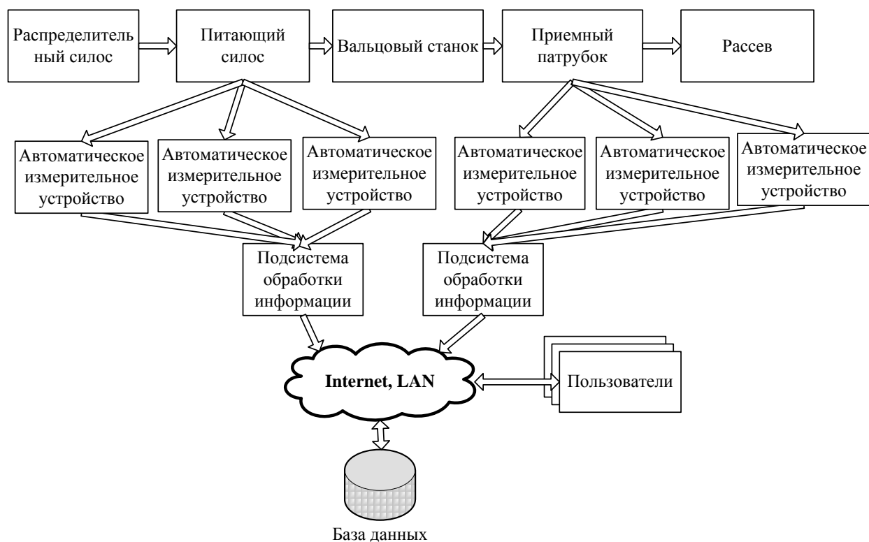
Рисунок 1 - Аппаратурная схема контроля потребительских свойств зерна и продуктов его переработки
