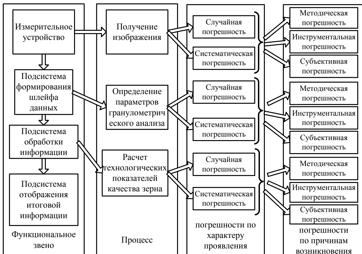
Рисунок 3 – Оценка различных видов погрешностей измерения, возникающих в ходе обработки данных оптического микроскопирования
