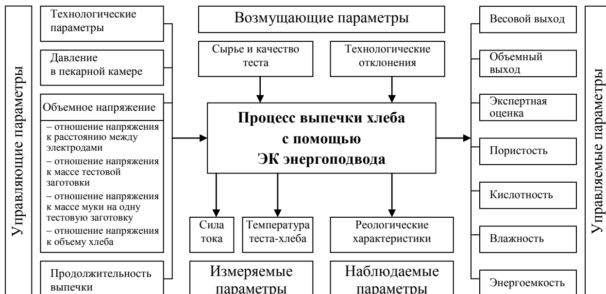
Рисунок 1 – Параметрическая схема процесса ЭК-выпечки хлеба
