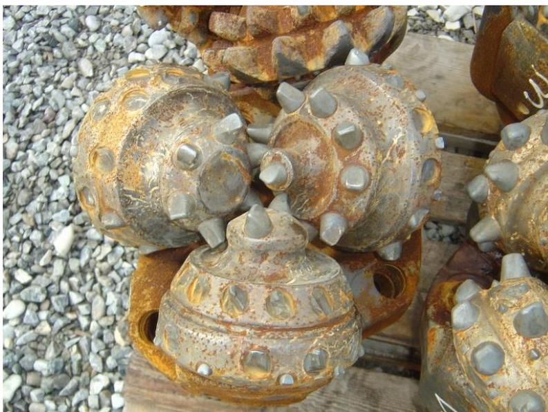
Рисунок 2 - Слом зубков трехшарошечного долота
