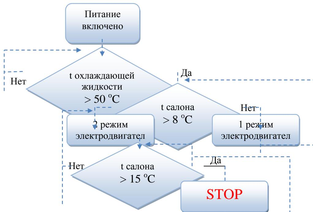
Рисунок 1 - Алгоритм работы устройства автоматического управления отопителем.
