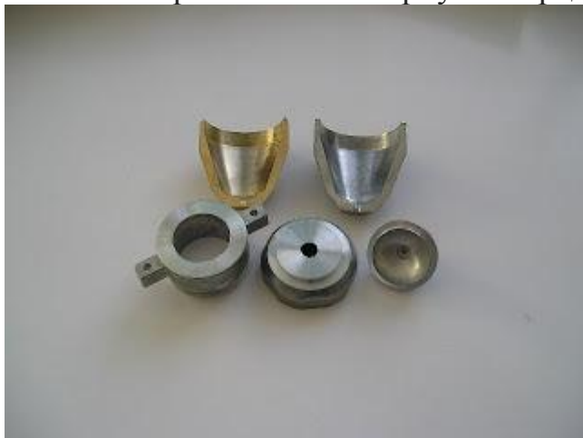
Фото 2. Отсутствие пор в корпусах.
