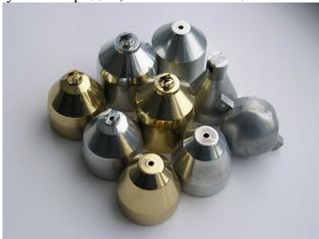
Фото 1. Корпуса кумулятивных зарядов, изготовленные методом литья.
