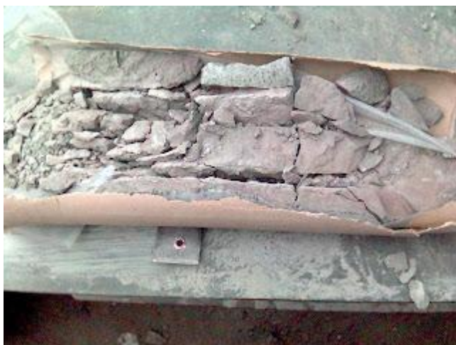
Фото 3. Трещины в бетонной мишени после выстрела кумулятивного заряда.
