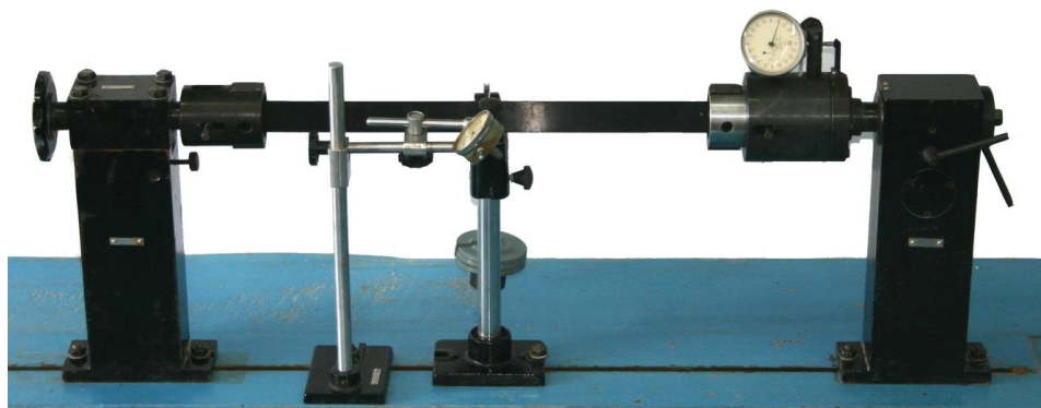
Рисунок 7- Исследование явления потери устойчивости сжатого стержня в упругой стадии
