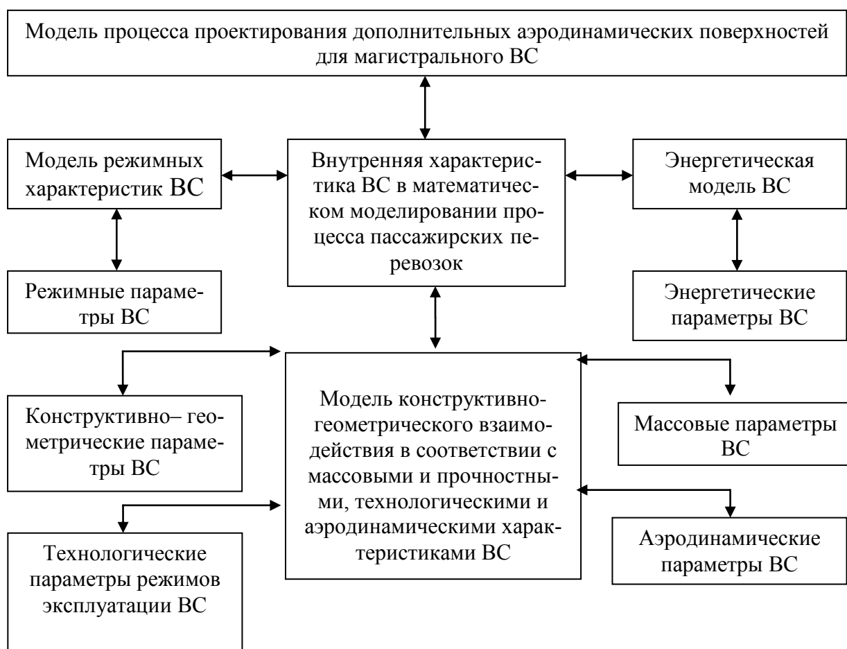
Рисунок 1 — Структура математической модели процесса проектирования дополнительных аэродинамических поверхностей для магистрального ВС
