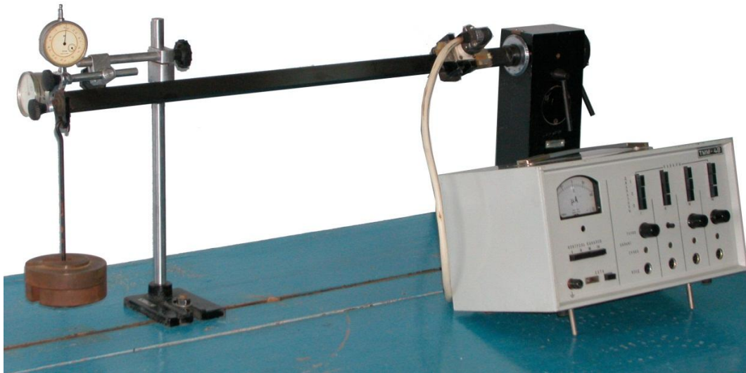
Рисунок 3- Испытание стержня на косо́й изгиб
