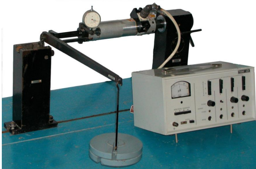
Рисунок 1- Исследование плоского напряженного состояния методом тензометрии
