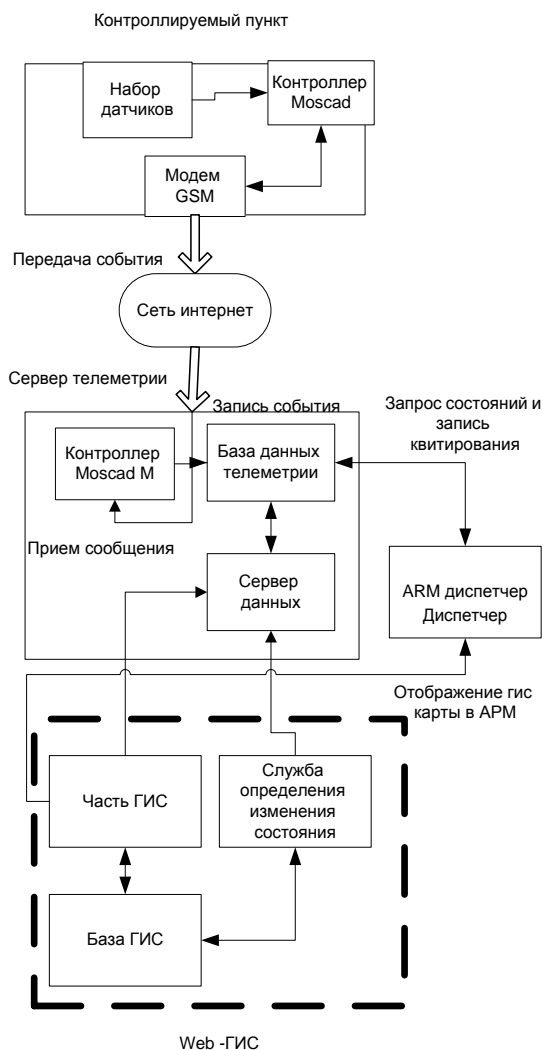
Рисунок 2. Общая схема модуля телеметрии ГРП. Выделяются ряд состояний, которые соответствуют слоям карты ГИС (представлены на рисунке 3):
