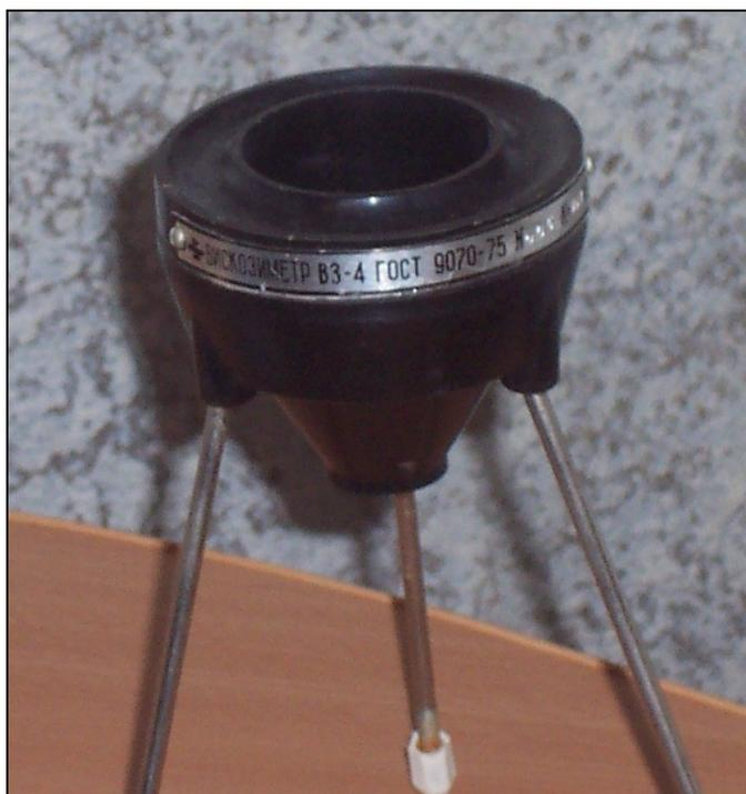
Рисунок 1 – Вискозиметр ВЗ-4
