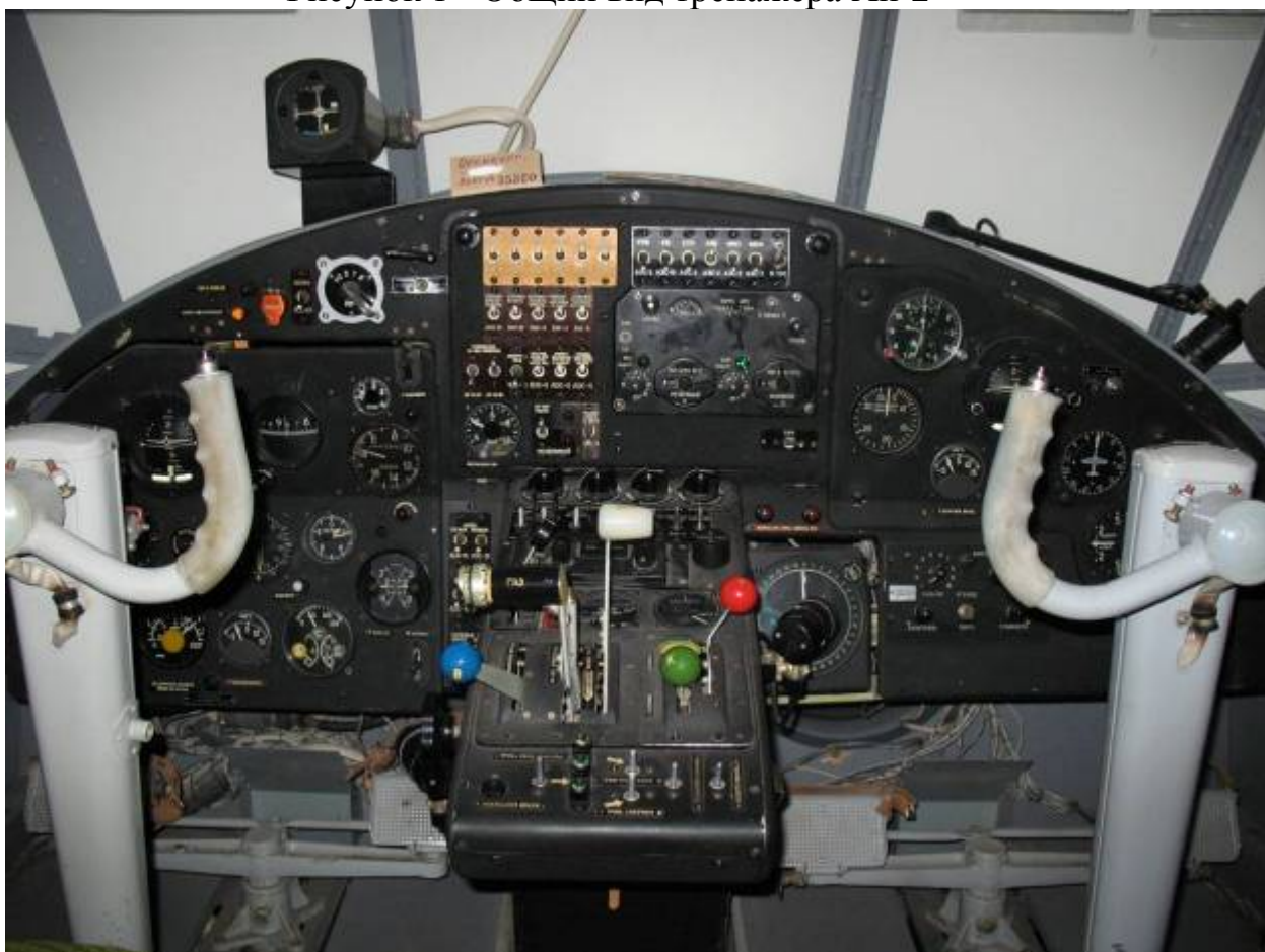
Рисунок 2 - Оборудование кабины тренажера Ан-2
