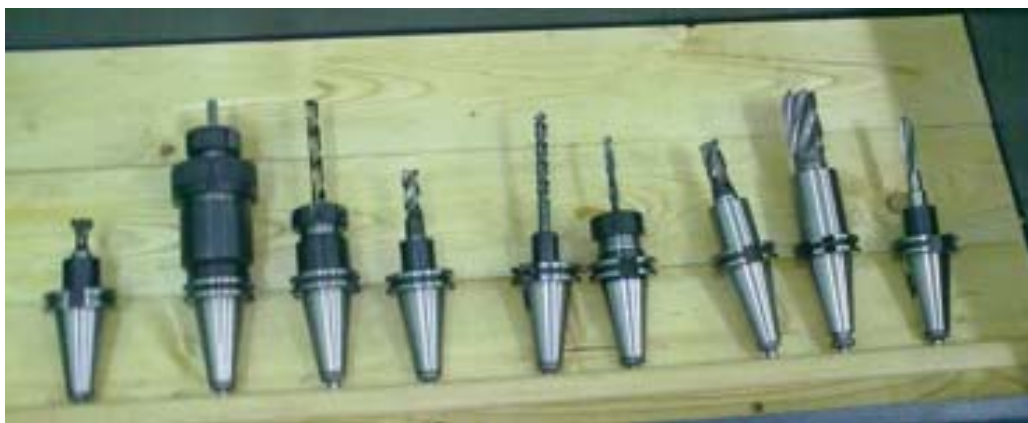
Рисунок 2 – Режущие инструменты, используемые на станке 400V
