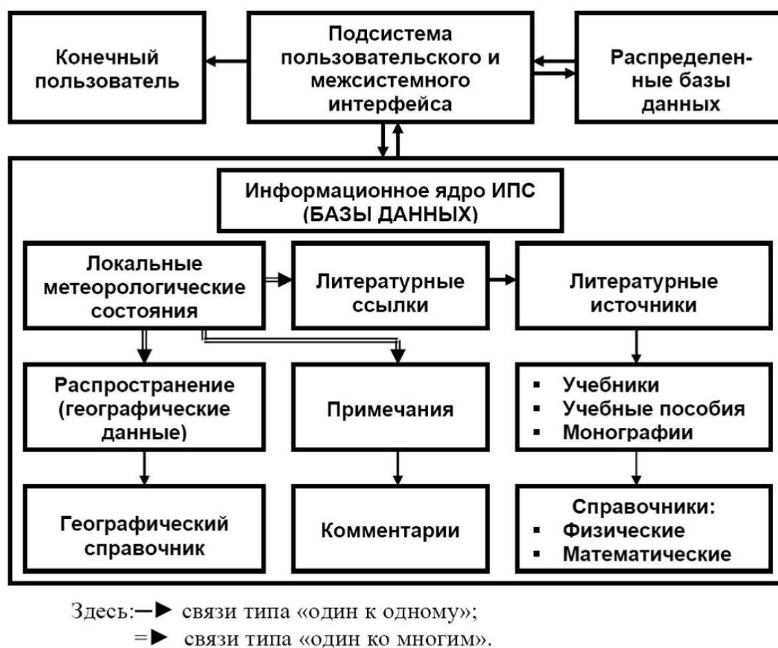
Рисунок 2 - Структурная схема информационно-поисковой системы, взаимодействующей с несколькими базами данных
