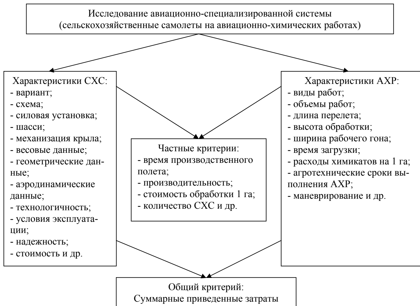
Рисунок 1 – Схема исследования самолетной системы
